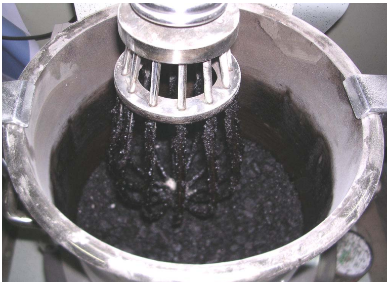
〈그림 1〉 골재와 아스팔트 바인더 혼합
