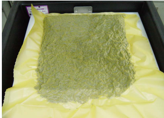
〈그림 2〉 공기를 제거한 후 비닐백 내부의 아스팔트 혼합물
